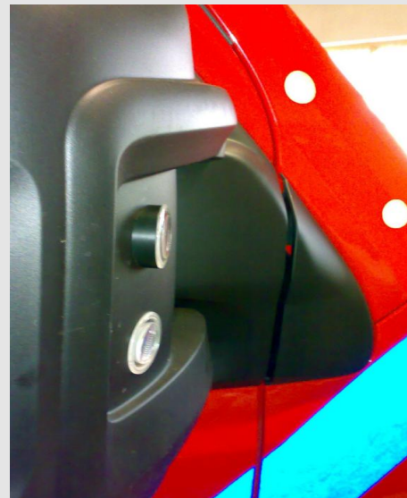
Spiegelmontage in rijrichting met behulp van uitvullingen
